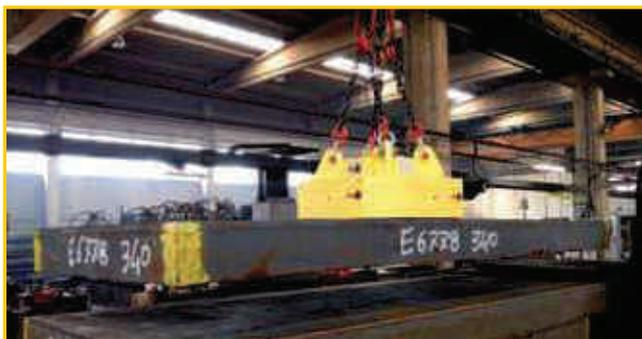
I moduli SEP sono stati ideati per la movimentazione di bramme e blocchi fucinati con elevati traferri.
